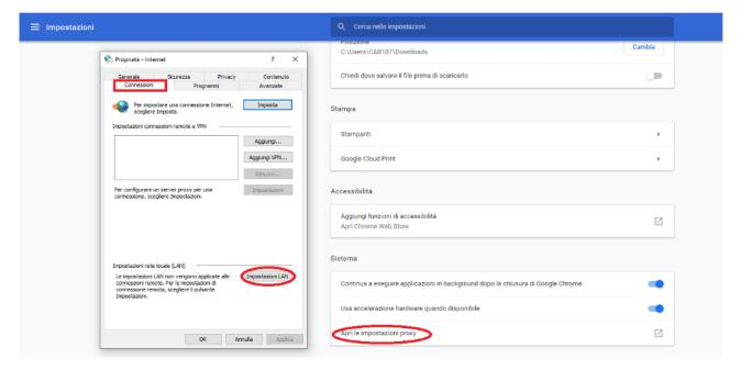
4- In Connessioni cliccare su Impostazioni LAN; spuntare l'opzione Rileva automaticamente impostazioni e in Server Proxy spuntare Utilizza un server proxy per le connessioni LAN
